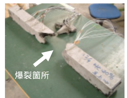
写真-1 加熱後の爆裂状況
