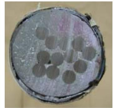
図-2 シース内のPC鋼材の内蔵状況
