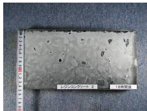
写真-1 摩耗試験後のレジンコンクリートの表面
