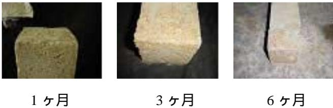
写真3 高炉スラグ供試体の劣化状況
