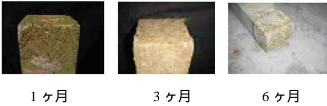
写真2 ポルトランド供試体の劣化状況
