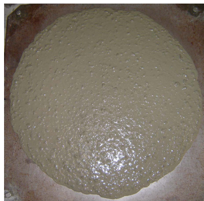
写真2 スランプフロー (Exp15 練上り)
