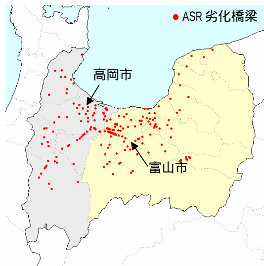
図-2 富山県内の ASR 劣化橋梁分布状況
