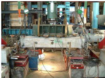
写真-1 載荷試験実施状況
