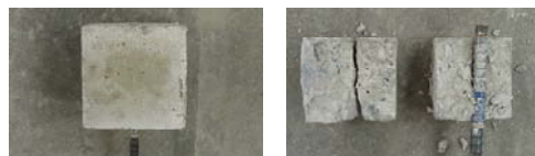
(a) 抜け出し破壊 (b) 割裂破壊
