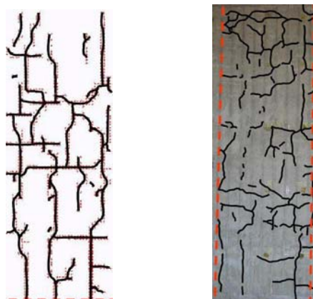
図 6 ひび割れモードの比較 (膨張率 \varepsilon = 0.225\% )
