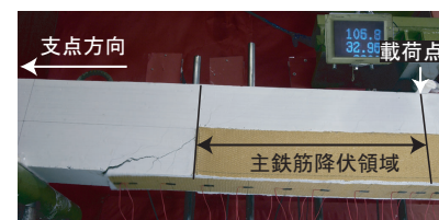
(a) ひび割れ状況
