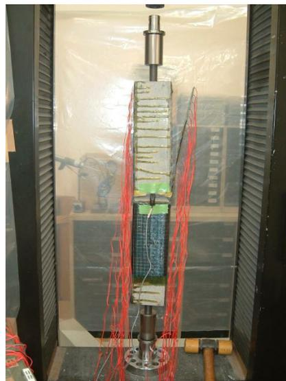
写真 1 S-1 破壊状況
