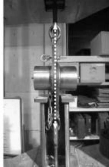
図-2 純せん断試験治具
