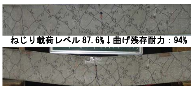
写真-1. ねじり載荷後 曲げ・せん断載荷：ひび割れ状況
