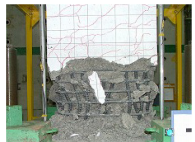
図 5 損傷状態（載荷面，載荷②）
