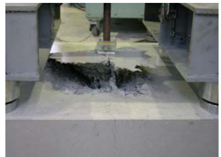
図-5 引抜きせん断破壊状況 (FRC)
