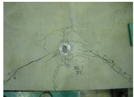
図-7 横圧せん断試験破壊状況 (FRC)
