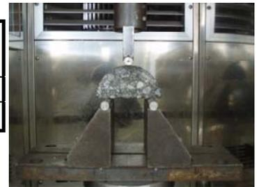
写真-1 SCB 試験状況
