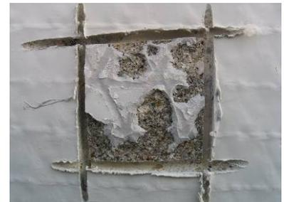
写真-2 No.1 破壊状況
