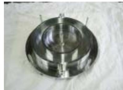
写真-1 リング型拘束ひび割れ抵抗性試験用型枠
