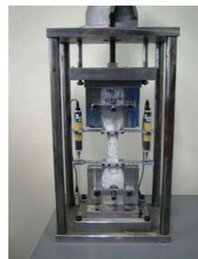
写真-1 引張試験装置
