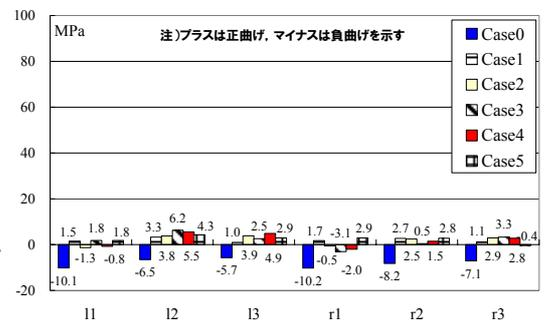
図 6 横梁主筋の発生応力の比較
