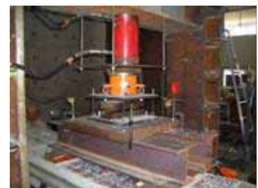
写真-1 荷重載荷装置
