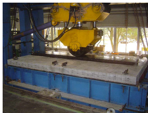
写真-2 輪荷重走行試験状況
