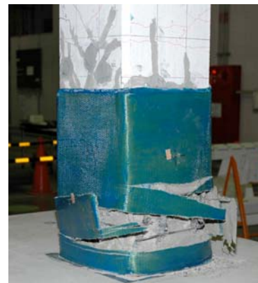
写真-1 A-1R 試験体の損傷状況
