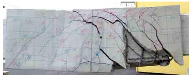
写真-2 試験終了時損傷状況 (Type2)
