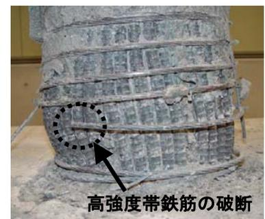
写真-4 No. ⑤柱基部破壊状況
