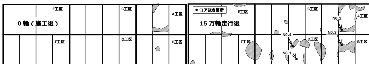
図-4 ひび割れ・はく離の調査結果
