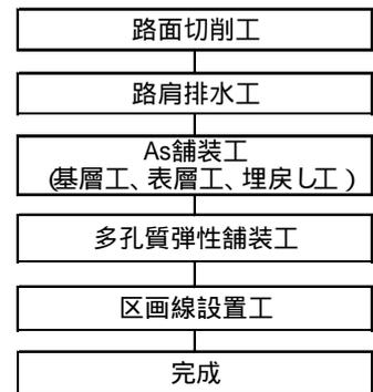
図-3 施工の流れ
