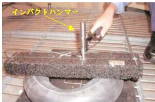
写真-1 自由支持打撃加振法
