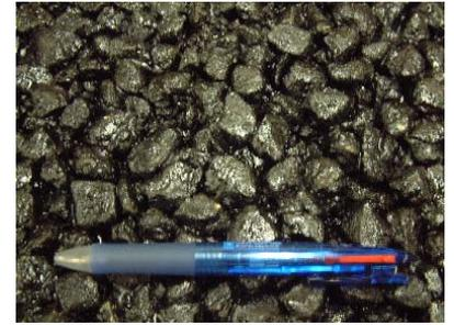
写真-1 基層混合物表面性状
