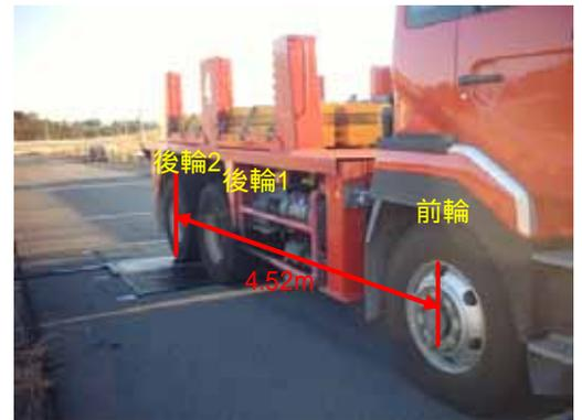
図-1 走行調査で用いた荷重車
