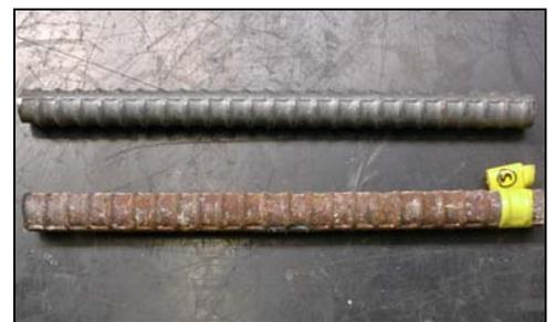
写真-1 腐食後の鉄筋の様子
