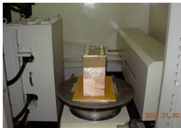
図-1 X-CT スキャナ装置にセットした供試体
