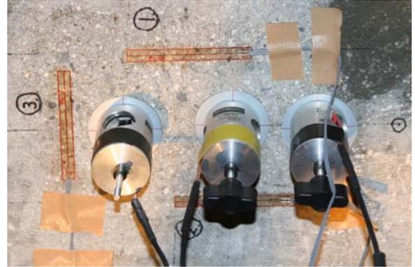
写真1 応力聴診器および従来型ひずみゲージの設置状況
