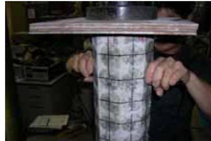
写真-1 超音波伝播速度の測定
