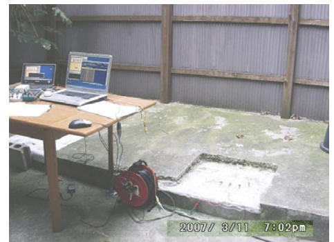
写真-1 埋設型浄化槽頂版の測定風景
