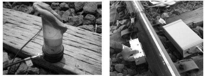
(a)斜角探触子 (b)探傷方法
