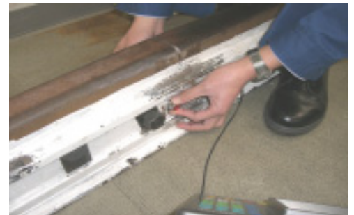
図-1 0度超音波透過試験の状況
