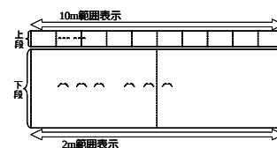
図3 Bスコープ探傷画像
