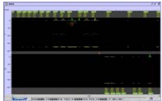
図-2 レール検測車傷グラフィック
