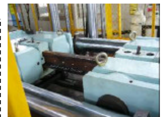
写真-2 軸力載荷装置(外観)
