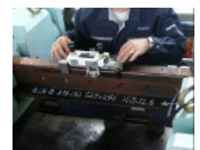
写真-3 軸力載荷時の探傷検査の様子
