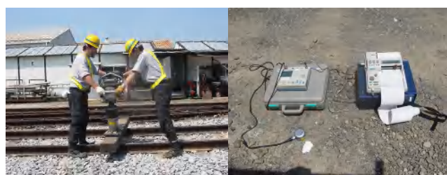
図－1 振動試験実施状況 (左: 起振風景 右: 測定器具 (リオン VM-52))
