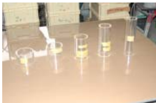
写真-1 フロー試験容器とフロー板
