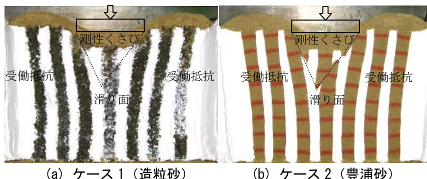
図-4 改良杭の破壊状況
