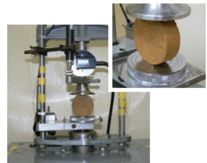
写真-1 割裂引張試験の状況
