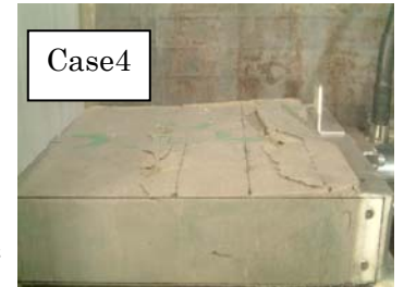
図-5 改良体の破壊状況
