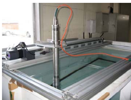
写真-4 実験水槽（水槽：幅 1m×高さ 1m×奥行き 2m）と本機器の設置状況
