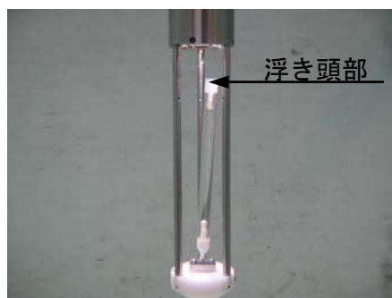
写真-5 実験時の浮き傾斜の様子
