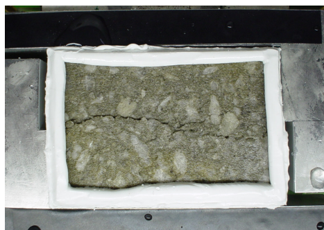
図-2 せん断割れ目のできた供試体
