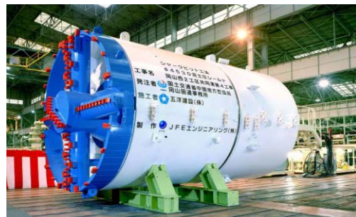
写真-1 φ4,530mm 泥土圧シールド機
