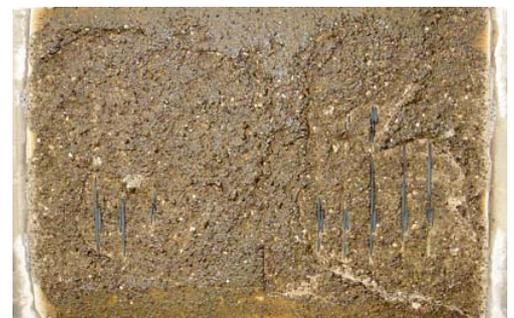
図-4 スランプ改良型継手部負曲げ試験体
