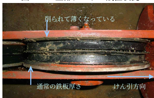
図-8 破断時の下部プーリーの状況
